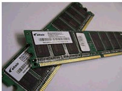
このメインメモリ自体がプリント基板で出来ていますが、下端の金メッキされている部分をメイン基板に差し込んで使用します。メモリの量を調整し易いように組み合わせて構成されています。
